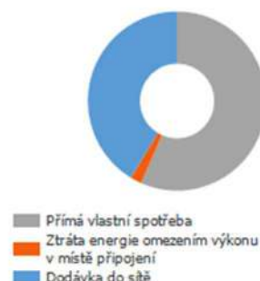
Energetický výnos FVE (AC síť) s baterií
