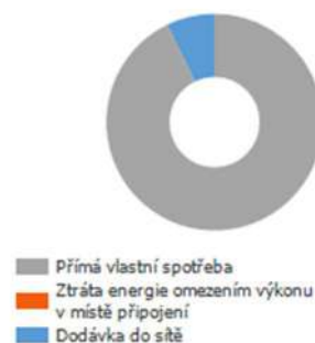
Energetický výnos FVE (AC síť) s baterií
