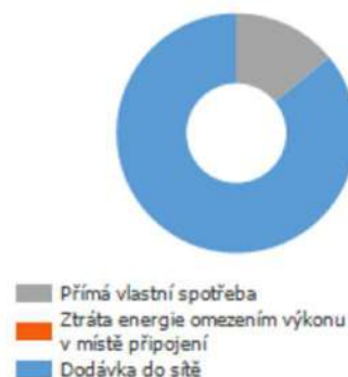
Energetický výnos FVE (AC síť) s baterií
